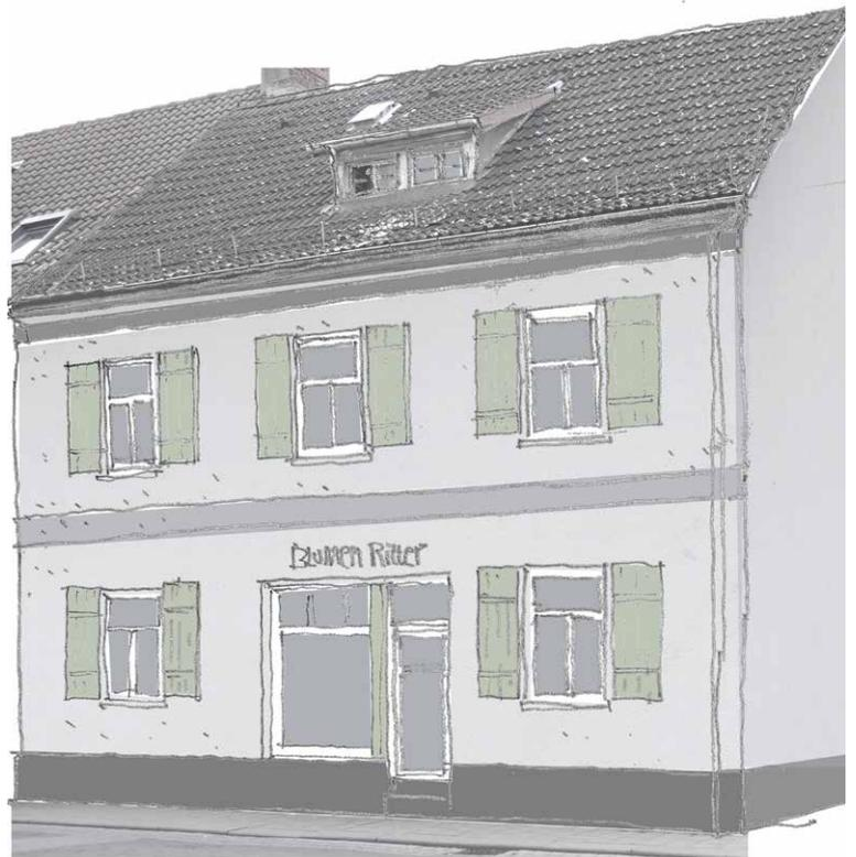
Das Haus ist im gesamten Fassadenbereich flächig mit keramischen Platten bekleidet. Dabei ist die ursprüngliche Gliederung der Fassade verlorengegangen. Reste davon sind nur im Dachbereich an der kleinen Gaube erkennbar. Bei der Wiederherstellung wird mit wenigen, aber deutlichen Details eine differenzierte Fassadengliederung mit einer plastischen Tiefenwirkung erreicht.
